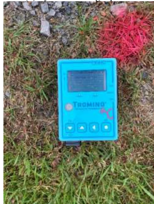
(d) Tromino device used to perform HVSR testing
